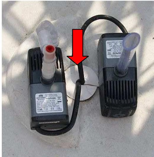
Im zweiten Schritt werden die Stecker nun durch die Öffnung in der Fußsäule **C** geführt.
